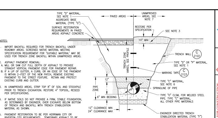
TYPICAL TRENCH BACKFILL SECTION
