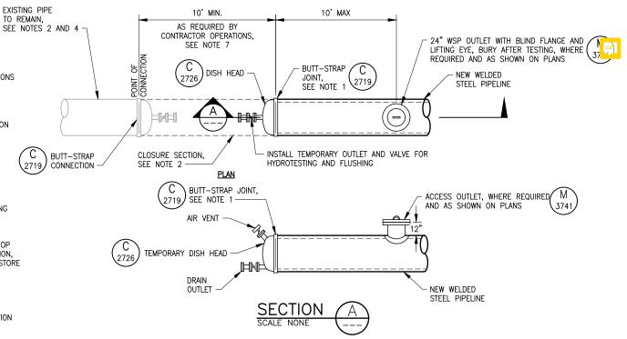
FINAL TIE-IN CONNECTION TO EXISTING PIPELINE C 2738
